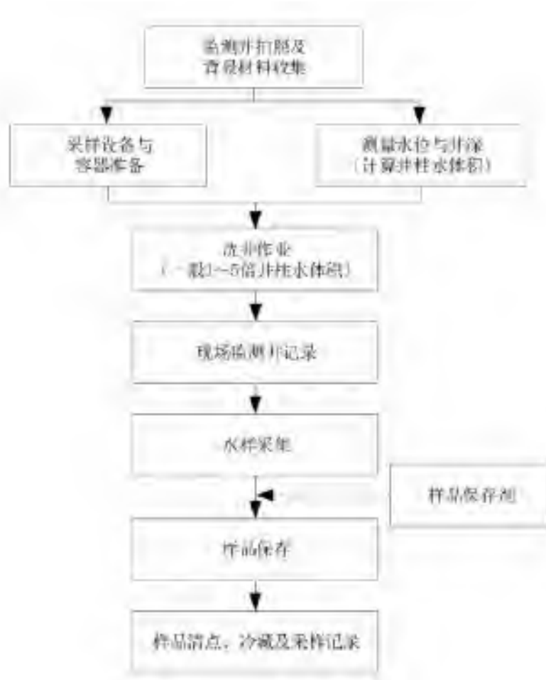
图 8.1 地下水采样基本流程图
