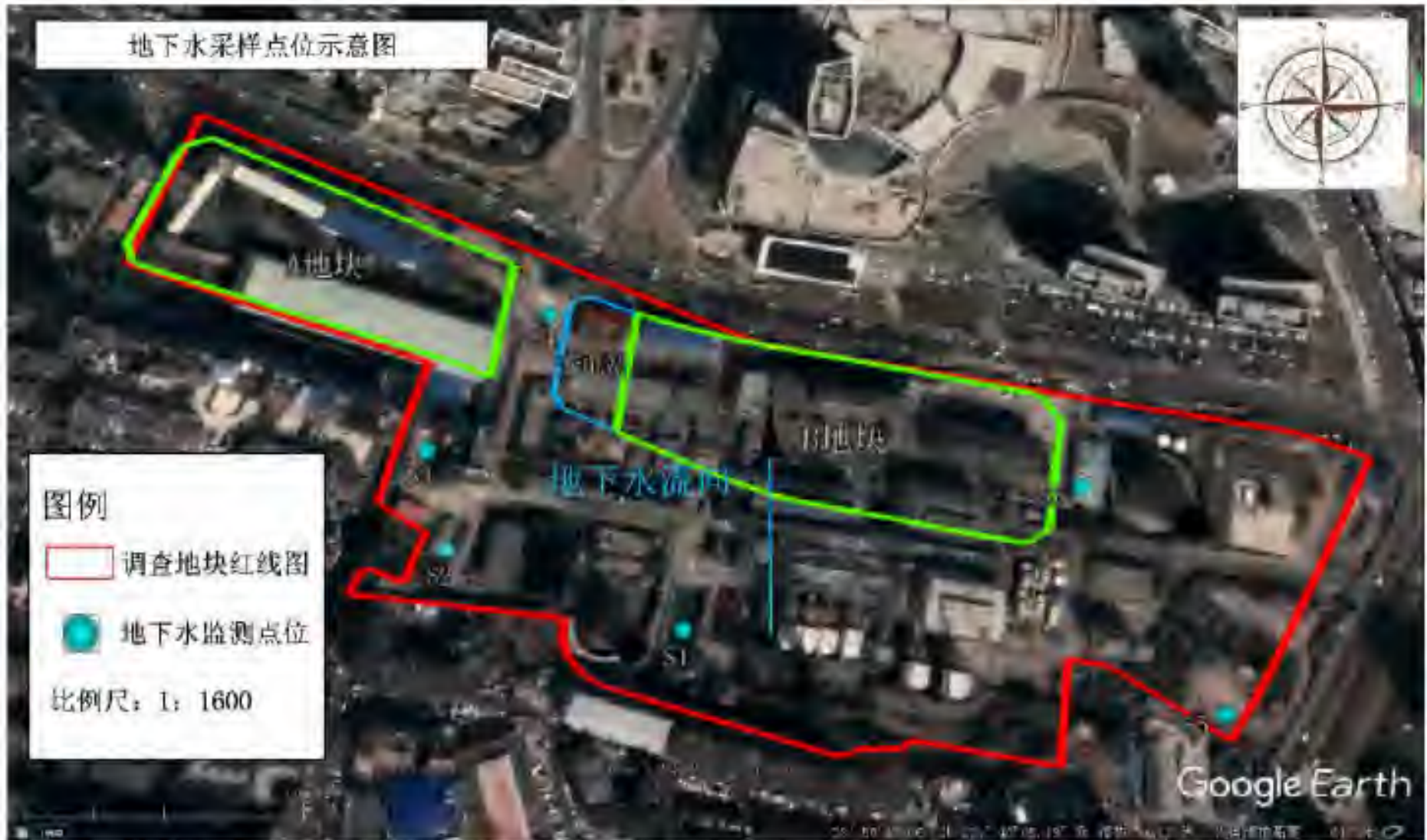
图 7.2 地下水监测布点示意图
